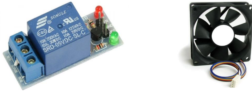
Figura 3- 12 Izq. Relé Arduino y Drcha. Fan.
