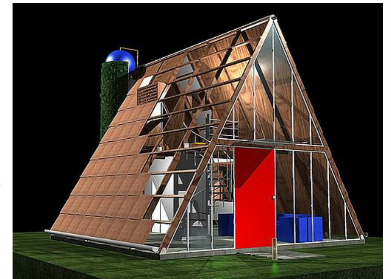
Ilustración 99: Esquema 3d de cerramiento básico de una casa Alpina
