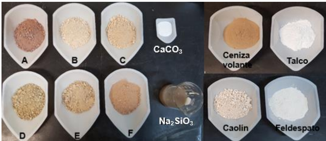
Figura 4. 1 Materias primas y aditivos para la obtención de probetas de cuerpo cerámico
