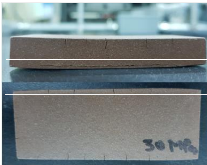
Figura 6. 11 Probetas sinterizadas aplicando la rampa P1.
