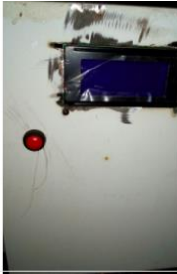
A. 3: Pulsador para Iniciar Proceso de Pesado
