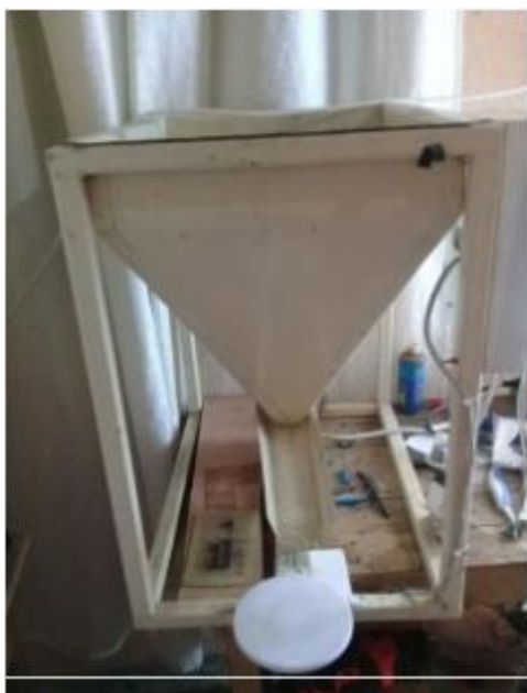
Figura 2. 39 : Estructura Metálica de la máquina de pesado automático. (Captura de Pantalla)
