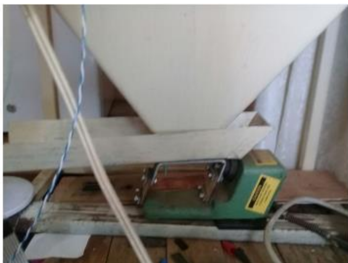
Figura 2. 38: Alimentador vibratorio ensamblado a la Máquina de pesado automático. (Captura de Pantalla)
