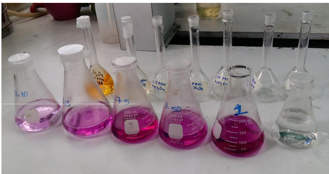
Figura 19. Soluciones de Cromo VI de 0,1 a 1,0 mg/L para la curva de calibración.
