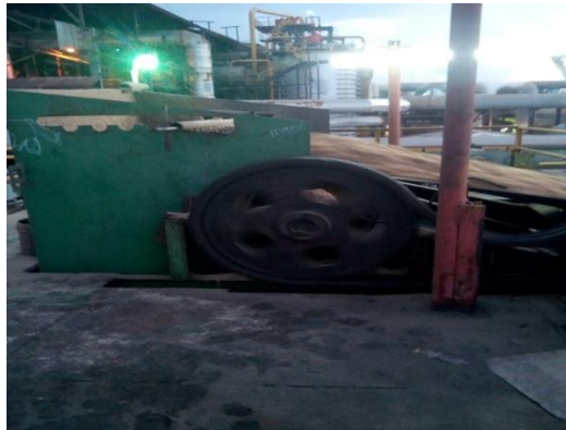
Figura 14. Alimentación de bagazo al difusor
