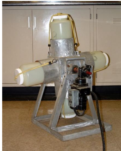
Figura 11. Desintegrador para medir el nivel de preparación (IP) de la caña
