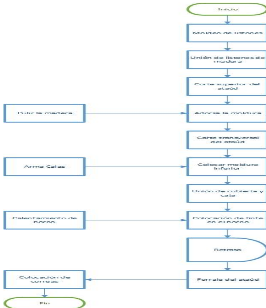
Ilustración 26: Diagrama de flujo para la fabricación de ataúdes de perfil medio
