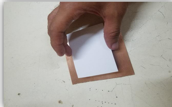
Figura 26. Papel Fotográfico en PCB
