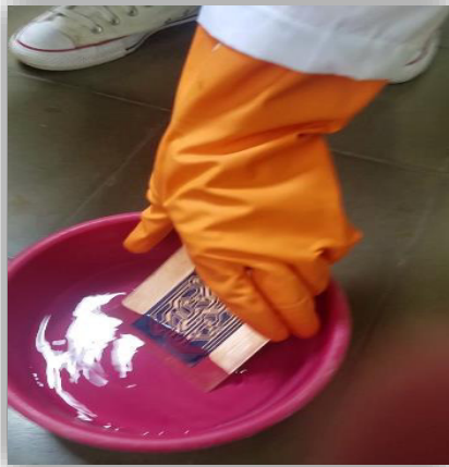
Figura 33. PCB Introducida al ácido
