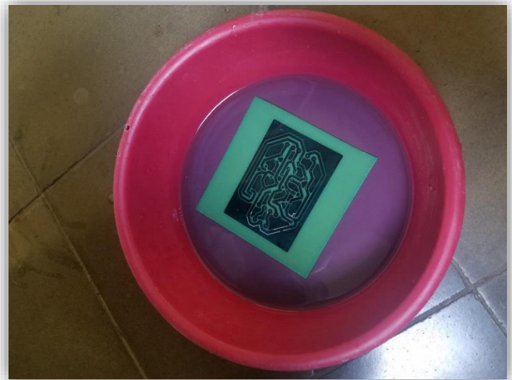
Figura 34. Desprendimiento de cobre en PCB
