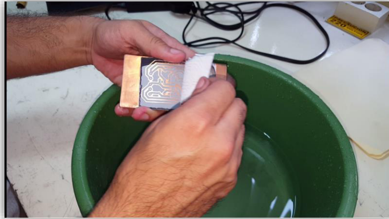
Figura 29. Remover Papel Fotográfico
