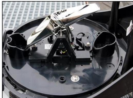
**Fig. 4.8b)** Parte interna del pluviómetro
