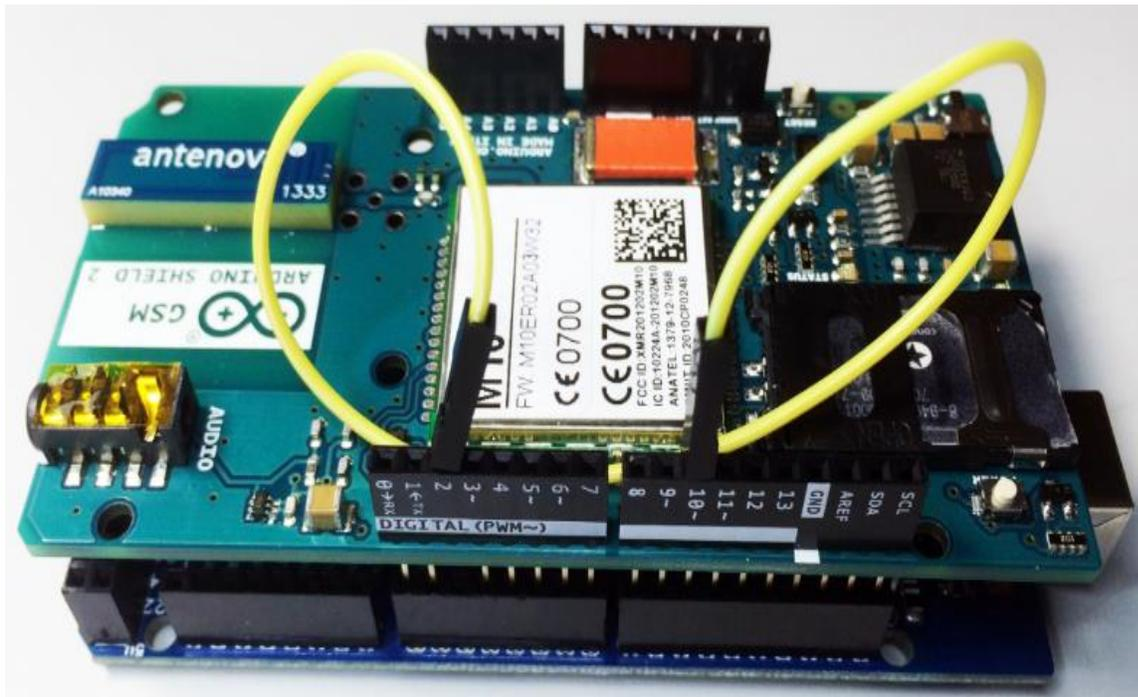
**Fig.4.22** Conexión de la Shield GSM 2 con el Arduino MEGA 2560
