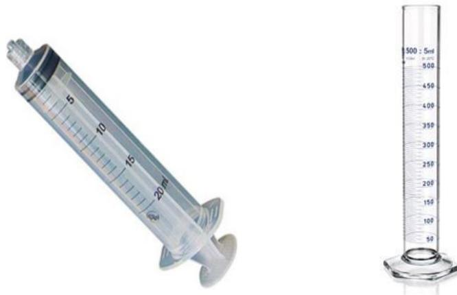
**Fig. 4.9** Instrumentos de calibración del pluviómetro.
