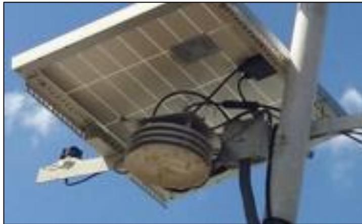
**Fig. 4.5** Conjunto de platos donde se encuentra el sensor DHT22 y MQ811
