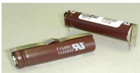
Figura 7: sensor para la medición de monóxido de carbono TGS5042
