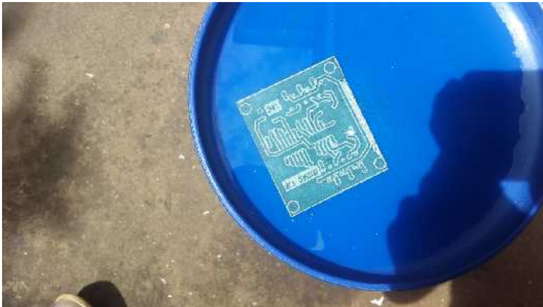
Ilustración 43 PCB en Acido nítrico
