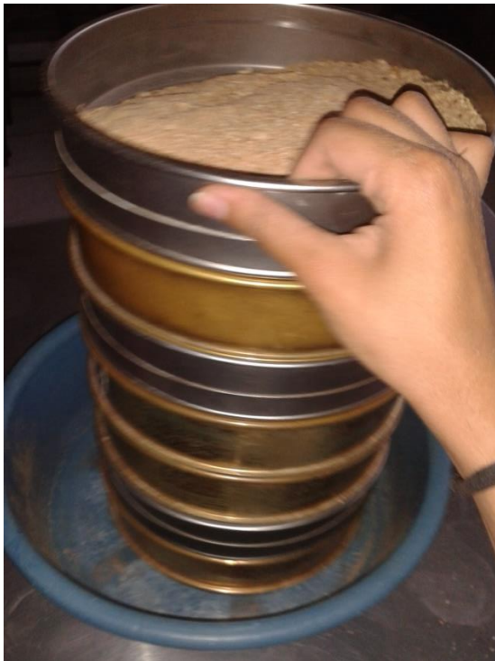
Figura 31. Prueba de Granulometría del Aserrín.
