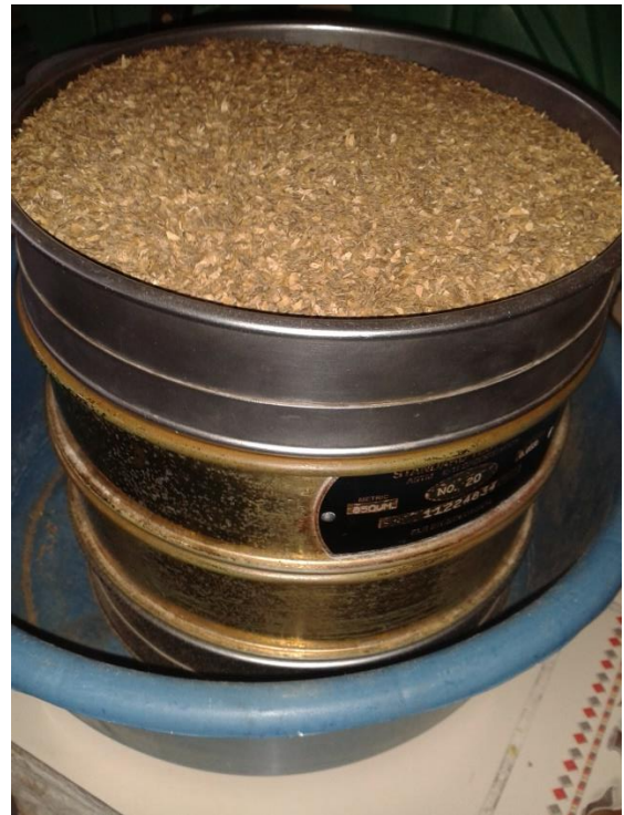
Figura 32. Prueba de Granulometría del Cisco.
