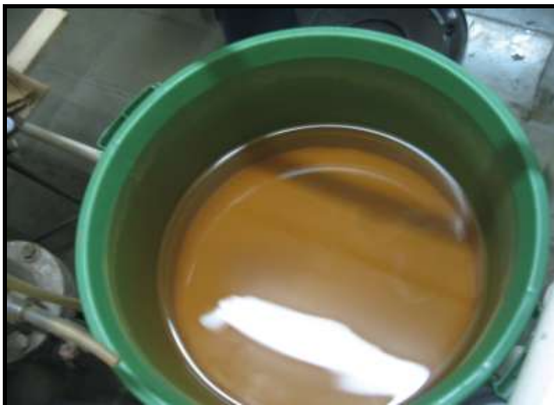
Foto 5 Lodos retenidos en el medio filtrante filtros KANCHAN
