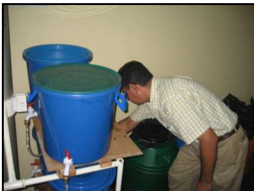
Foto 2 Filtro SONO modificado, instalado en el laboratorio del CIEMA - UNI
