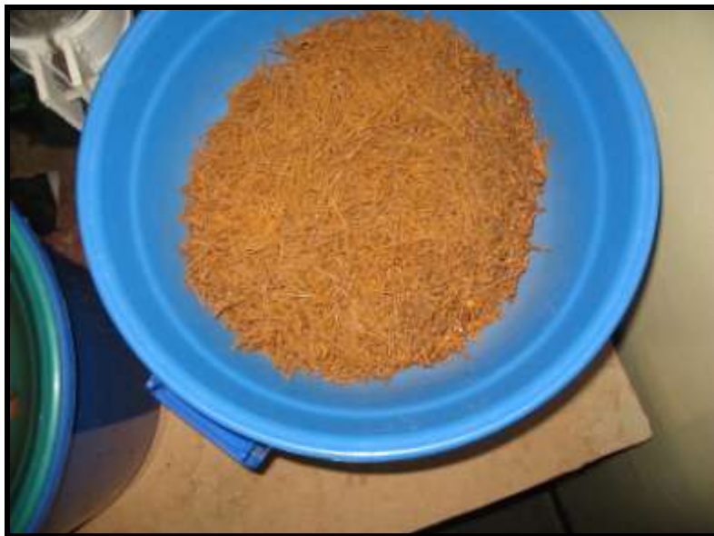
Foto 4 Clavos de hierro < 20 mm, previamente oxidados
