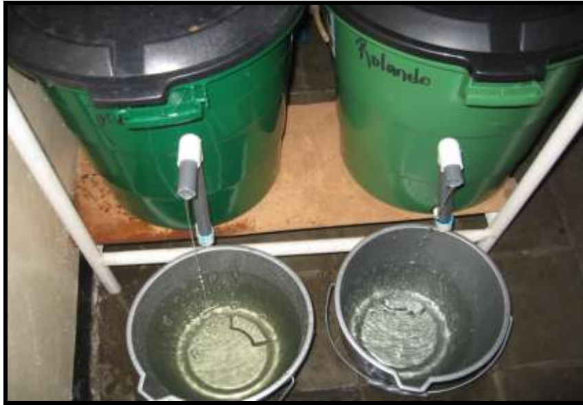
Foto 3 Recolección de agua tratada del filtro KANCHAN instalado en el laboratorio del CIENA – UNI
