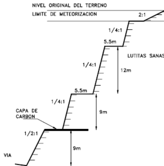
Ilustración 36 Configuración típica de taludes en lutitas sanas
