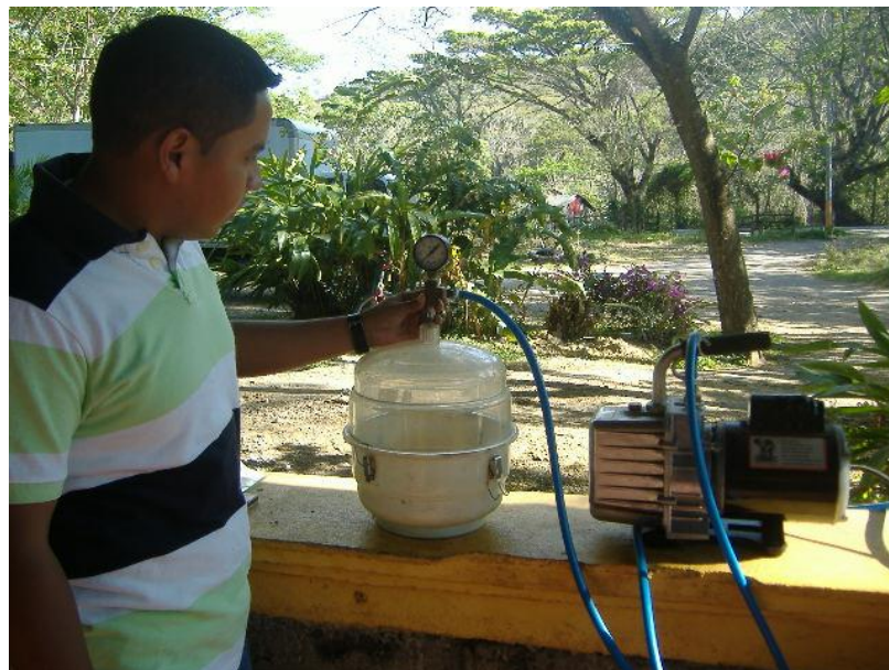
Foto 20: Picnómetro de vacío para ensayo de gravedad específica máxima RICE.
