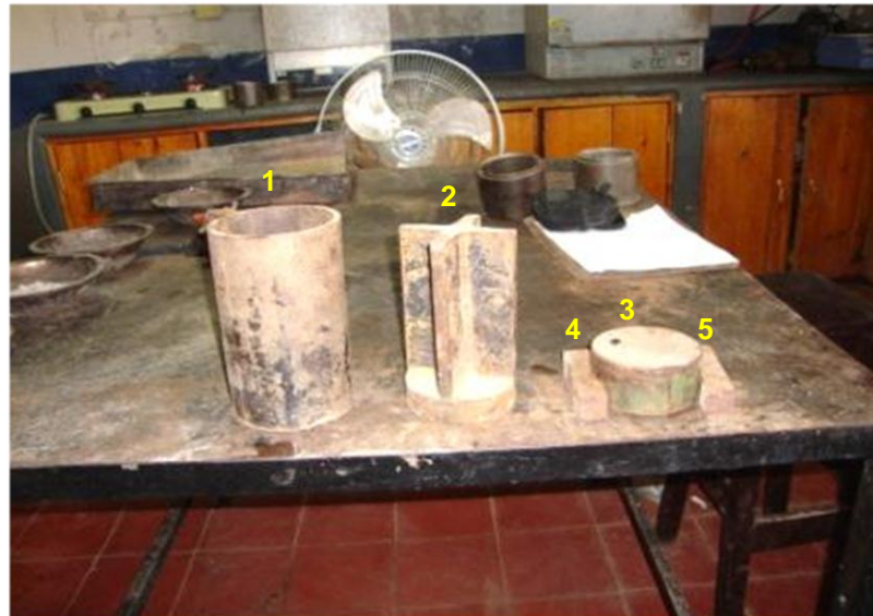
1: Molde de 101.6 m.m x 101.6 m.m, 2: Pistón superior. 3: Pistón inferior, 4 y 5: Juego de separadores
