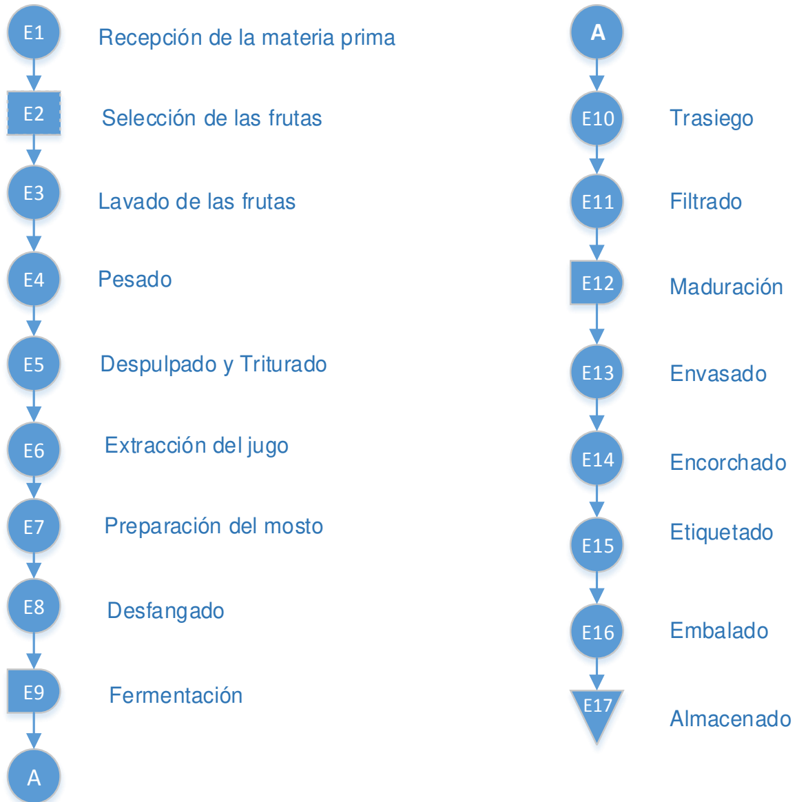
Figura N° 3.1: Diagrama de flujo de proceso para elaboración del vino de piña
