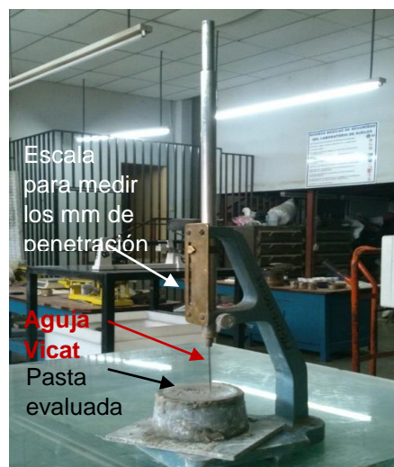
Figura 6: Aparato Vicat utilizado para determinar el tiempo de fraguado del cemento
