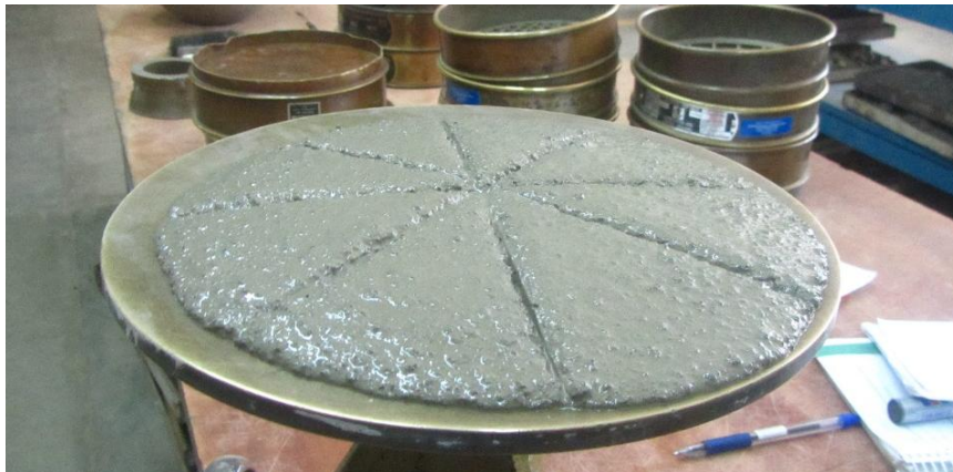
Figura 10: Apariencia del Mortero de la Mezcla 1 después de haberse determinado el diámetro promedio ensanchado por efecto de los golpes aplicados en la mesa de fluidez.
