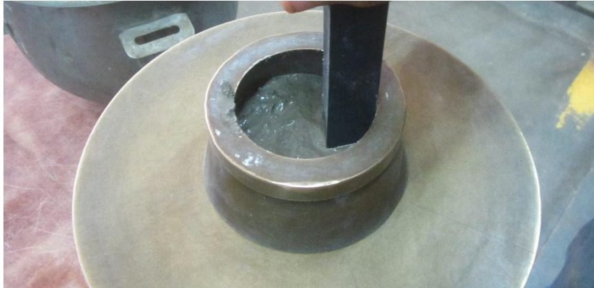
Figura 9: Aplicación de los golpes con el tamper al mortero de la Mezcla 1 dentro del molde troncónico, ubicado al centro de la mesa de fluidez.
