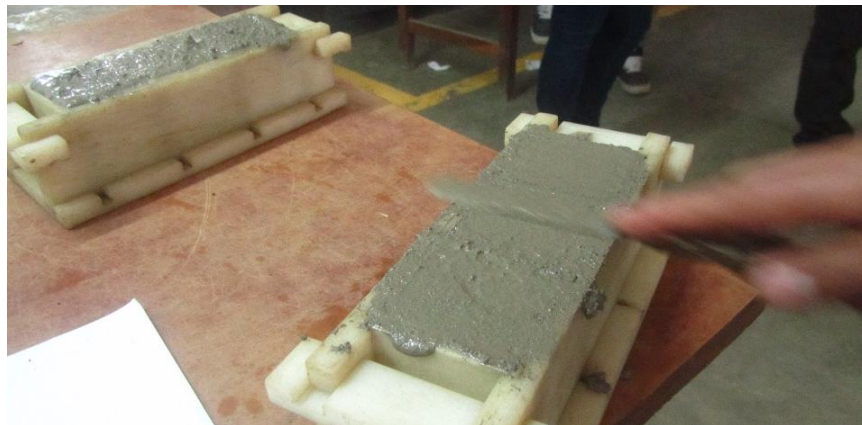
Figura 12: Enrasado del mortero de la Mezcla 2
