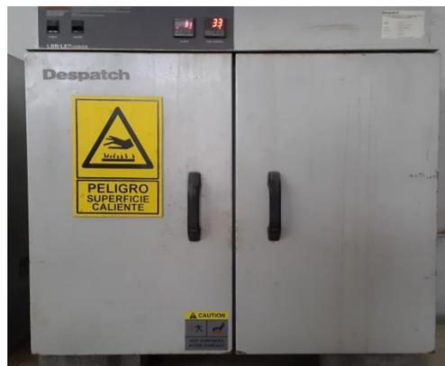
Figura 4.4 Horno para acondicionamiento de agregado
