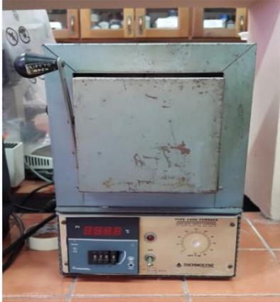
Figura 4.5 Mufla utilizada para la calcinación
