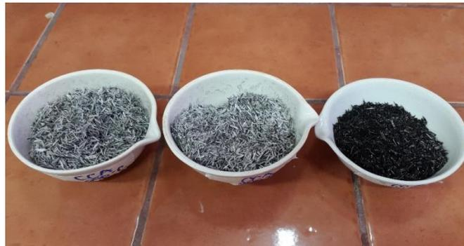
Figura A.2 Cascarilla de arroz calcinada a distintas temperaturas
