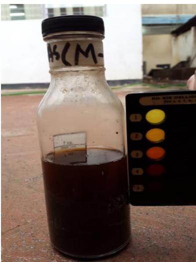
Figura 5.3 Impurezas orgánicas de agregados por Colorimetría
