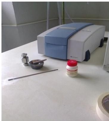
Figura 4.8 Espectroscopio infrarrojo para análisis FT-IR
