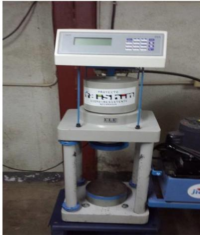
Figura 4.3 Máquina compresora
