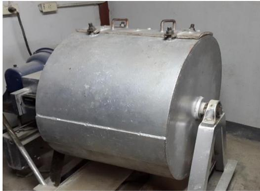
Figura 4.1 Molino de bolas o máquina de desgaste de materiales
