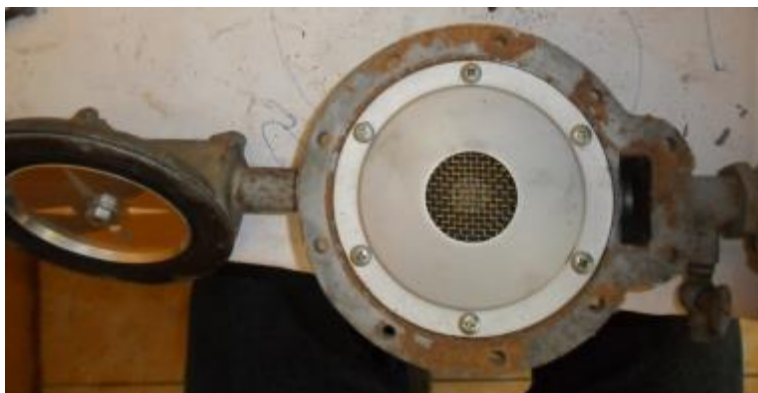
Figura 14 Izquierda, Válvula de Diafragma; derecha, Válvula Check con el sello desecho.
