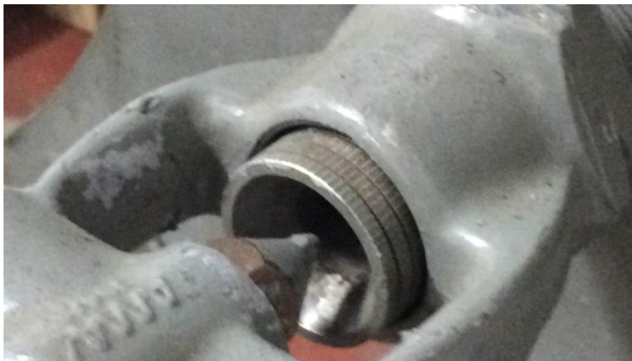
Figura 29. Anillos ( 2\frac{1}{2} ) en la camisa reguladora de la mezcla aire-combustible.
