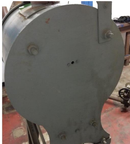
Figura 34. Agujero donde entraba el instrumento de medición anterior.
