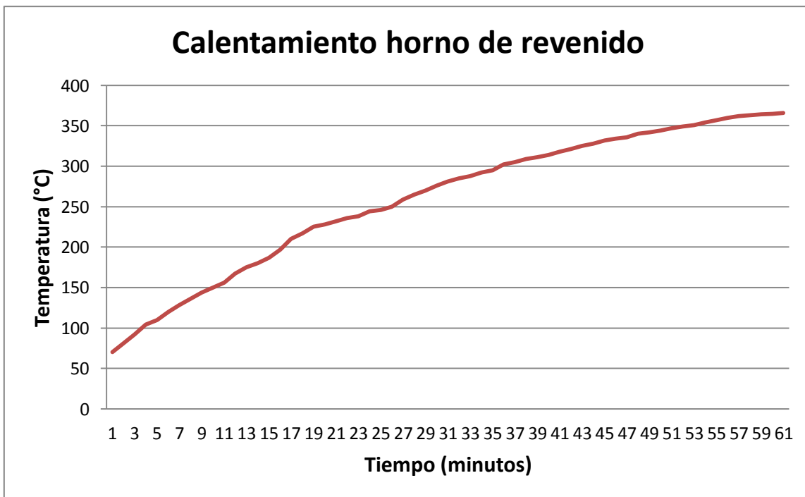
Gráfica 1 Temperatura - Tiempo de calentamiento del horno de revenido.
