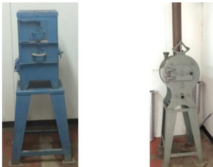
Figura 10. Hornos sin tubería de suministro de gas
