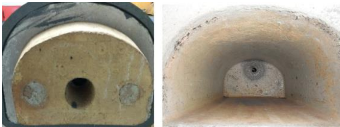
Figura 19. Izquierda, Compuerta del Horno de revenido. Derecha, su recámara. El agujero del fondo es para introducir el termopar.
