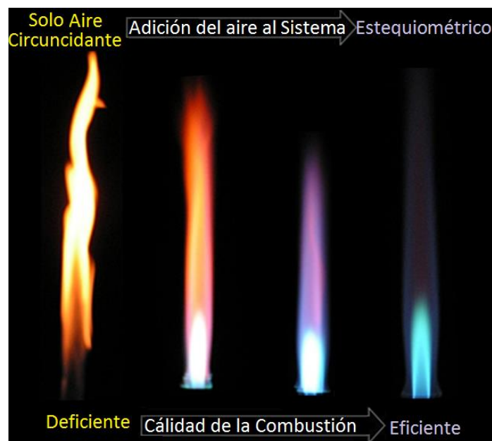
Figura 27. Imagen que refleja el cambio en el color de la llama según el suministro de aire al sistema durante la combustión.
