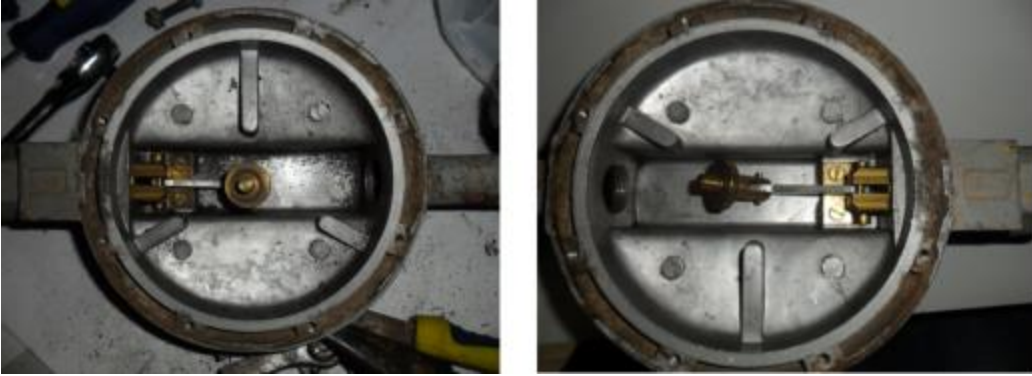
Figura 15. Izquierda, Válvula de Diafragma previa a la limpieza; derecha, válvula ya limpia.
