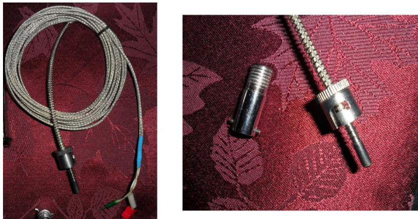
Figura 35. Termopar tipo bayoneta "K" con conector fijo y longitud de penetración ajustable.
