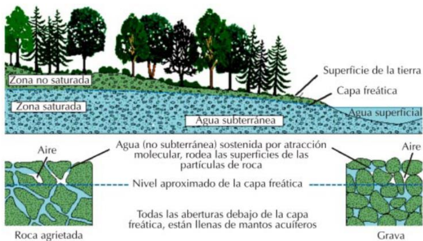
Figura No. 3.1: Componentes de un acuífero
