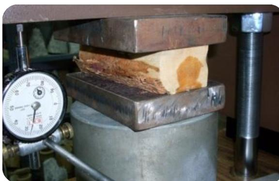
*Fig. 7. Ensayo para la obtención de la resistencia a la compresión perpendicular a las fibras de una especie de madera*
