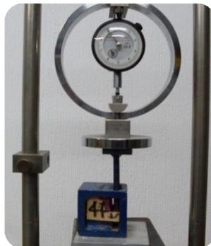
**Fig. 8.** Ensayo para la obtención de la resistencia a la compresión perpendicular a las fibras de una especie de madera
