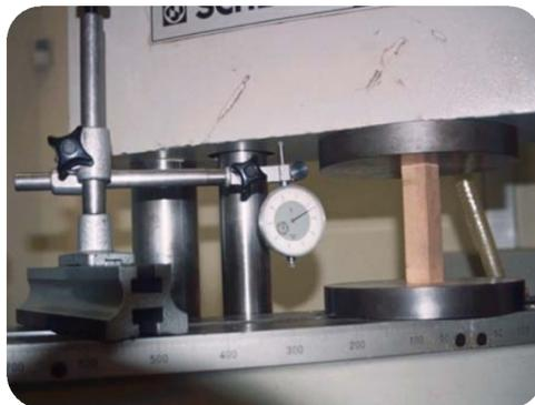
**Fig. 6.** Ensayo para la obtención de la resistencia a la compresión paralela a las fibras
