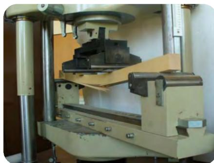
**Fig. 9.** Ensayo para la determinación la resistencia a la flexión estática
