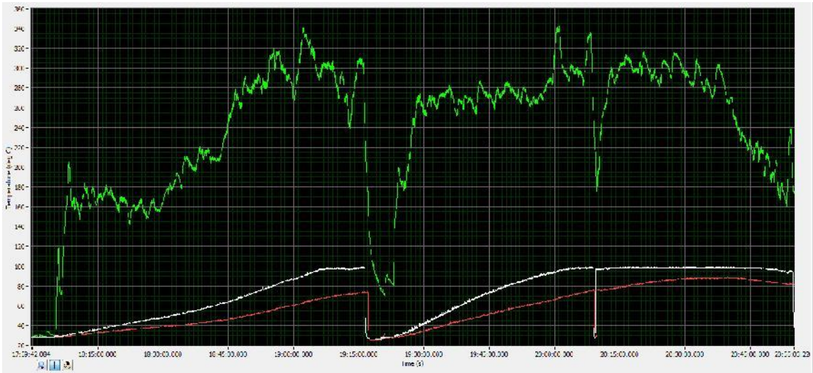
Figura 5 – Visualización de datos típicos de una prueba de WBT. La línea superior representa la temperatura de la chimenea. Las líneas inferiores corresponden a las ollas.
