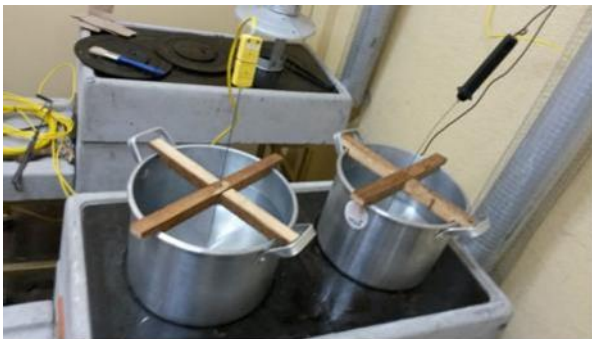
Foto 3 – Instalación de termocuplas para adquisición de datos en agua y gases de chimenea.
