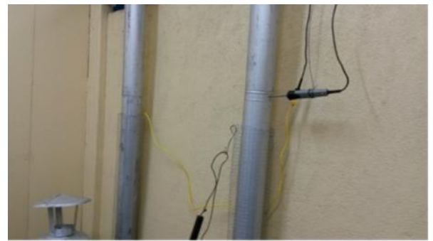
Foto 3 – Instalación de termocuplas para adquisición de datos en agua y gases de chimenea.
