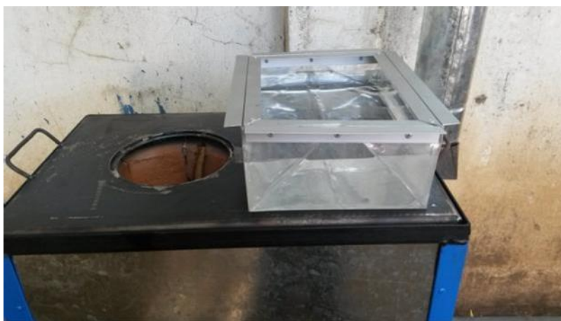
Foto 6 – Configuración del sistema de evaluación para cocina plancha mini eco fogón en base a recipiente de Mylar
