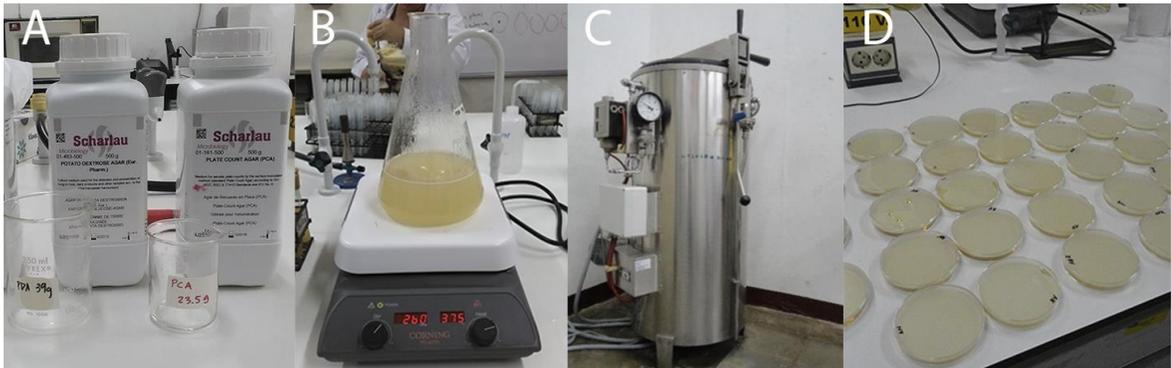
**Figura 10.** Preparación de los medios de cultivo. A: Medios de cultivo comerciales en sus envases; B: Calentamiento del medio de cultivo en el Hot Plate; C: Esterilización en el autoclave a 121°C durante 15 minutos; D: Placas Petri con el medio de cultivo solidificado.
