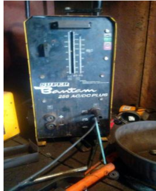
Imagen 26: Soldador por arco eléctrico Es un soldador de uso múltiple de mayor capacidad.
