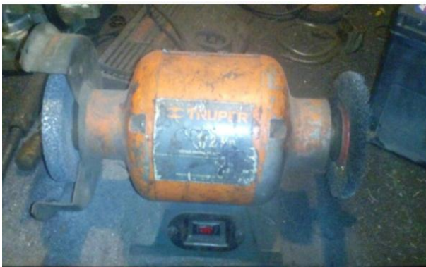
Imagen 28: Esmeril eléctrico Para esmerilar y pulir
