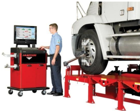
Imagen 11: Máquina utilizada para alineación y balanceo computarizado
