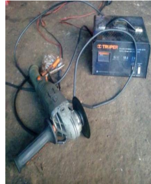
Imagen 27: Esmeriladora y cargador de batería Esmerilar y cortar metal y madera
