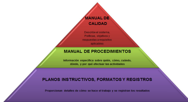
Figura No. 02: Jerarquía del sistema de calidad. Fuente: Norma UNE-EN ISO 9001:2008. Manual de calidad.
