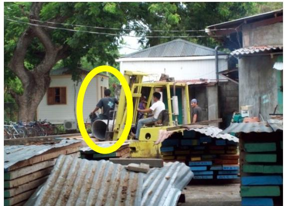
Fig.4: Mal uso de montacargas
