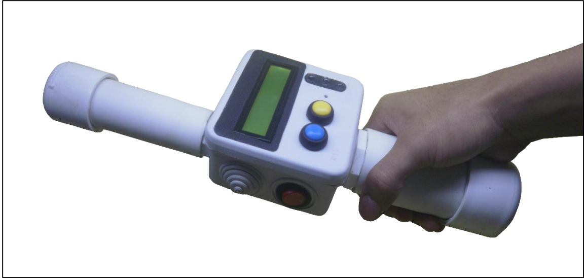
Figura AIX.5 Bastón lector ISO 11784/85 en uso.
