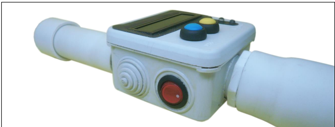
Figura AIX.7 Detalles de los botones del bastón lector ISO 11784/85.
