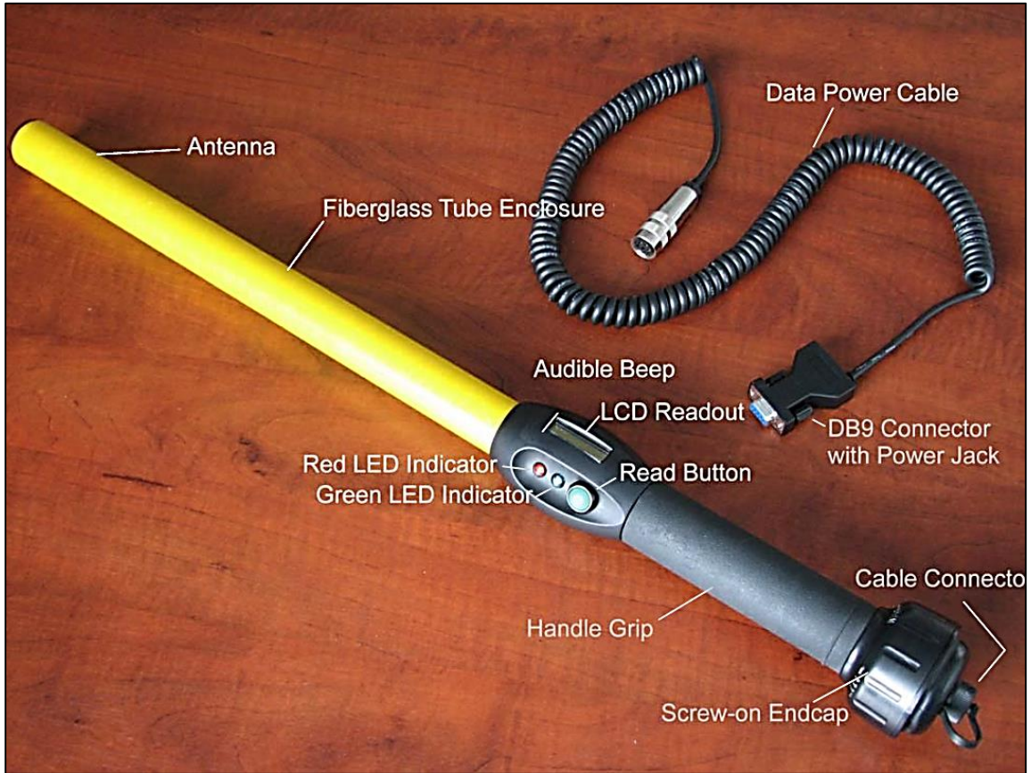
Figura All.29 Allflex RS320™ (partes).
