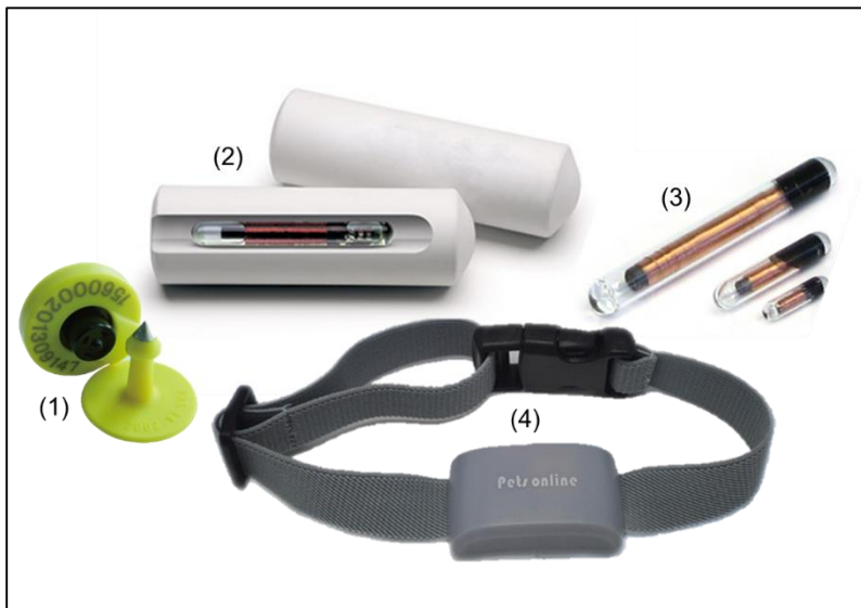
Figura 5.7 Diferentes transpondedores dedicados a la ID animal. (1) Aretes para ganado, (2) Bolus rumen, implantes estomacales para rumiantes, (3) Implantes subcutáneos y (4) collares.
