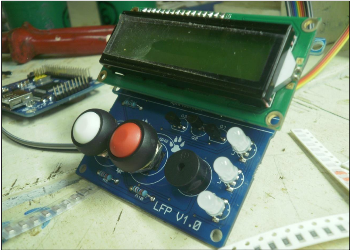
Figura AX.19 Montaje de los componentes en el PCB de interfaz de usuario (adelante).
