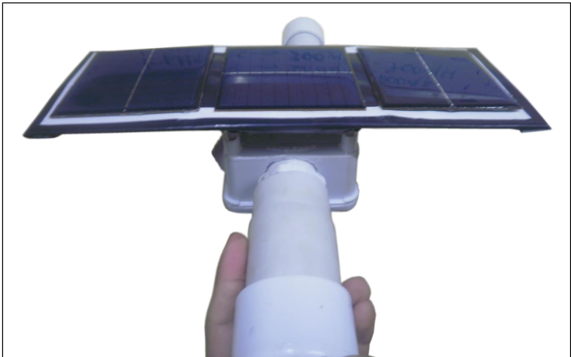
Figura AV.33 Arreglo fotovoltaico conectado al lector (vista inferior).
