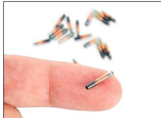
Figura 1.17a Transpondedor cápsula de cristal subcutánea de 32mm fabricado por Texas Instruments .
