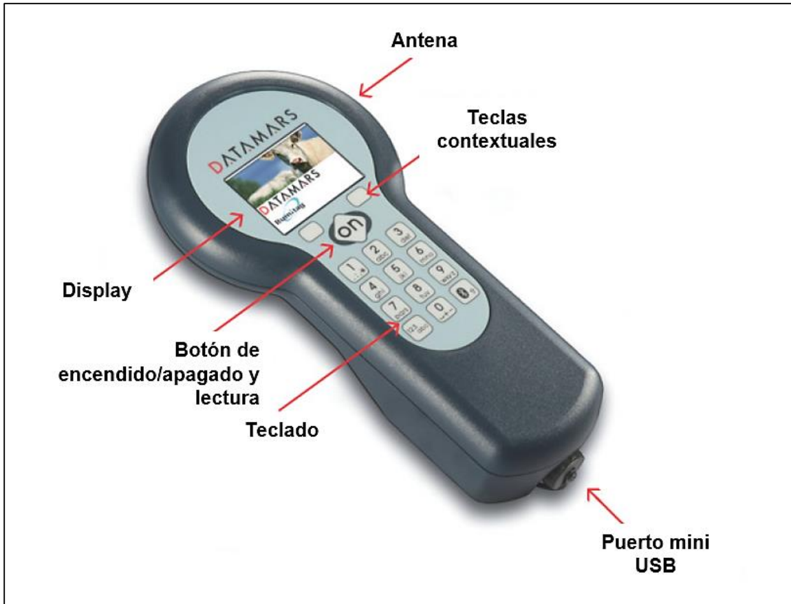
Figura AII.111 DATAMARS GES3S™ (partes).
