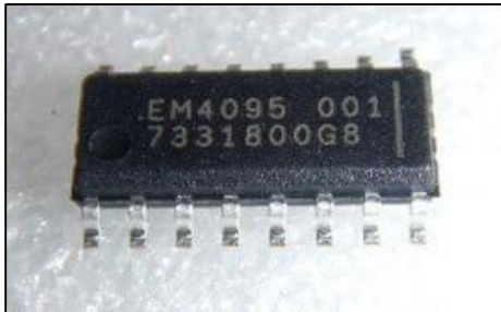
Figura 4.1 Chip EM4095 fabricado por “EM Microelectronic™”.
