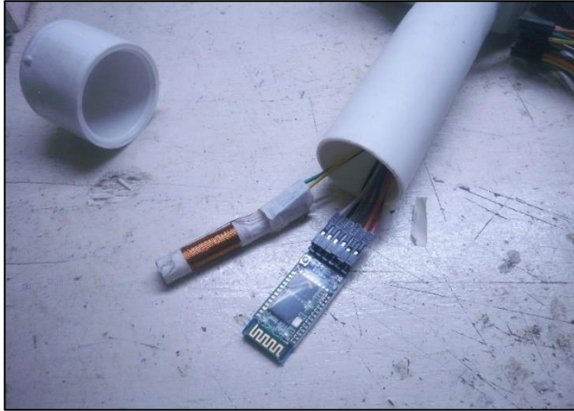
Figura R.18 Antena con núcleo de rodo de ferrita y modulo Bluetooth ensambladas en el tubo superior del lector.
