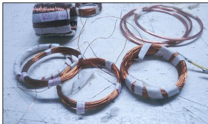
Figura R.17 Antenas fabricadas. El valor de cada una es de aproximadamente 400\mu\text{H} y el diámetro es de 3\text{cm} .
