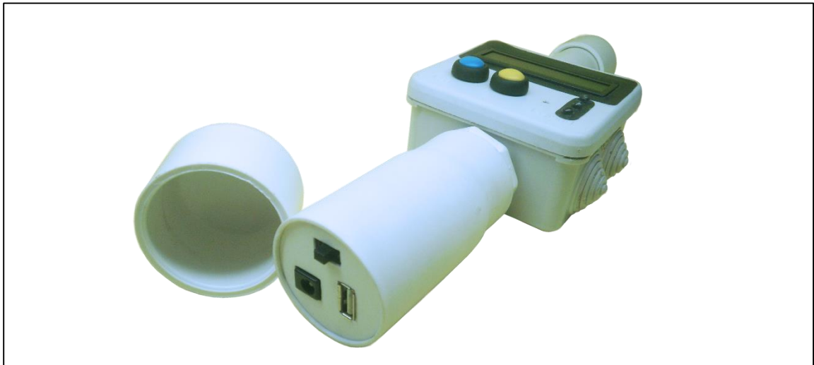
Figura AIX.6 Detalles de la parte inferior del bastón lector ISO 11784/85.
