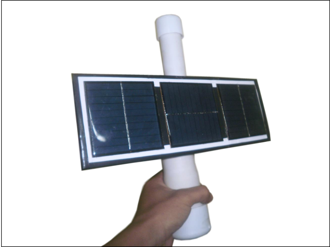
Figura AV.32 Arreglo fotovoltaico conectado al lector.
