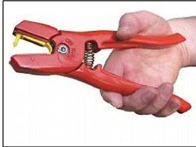
Figura 5.8 Aplicador para transponde- dores tipo arete.
