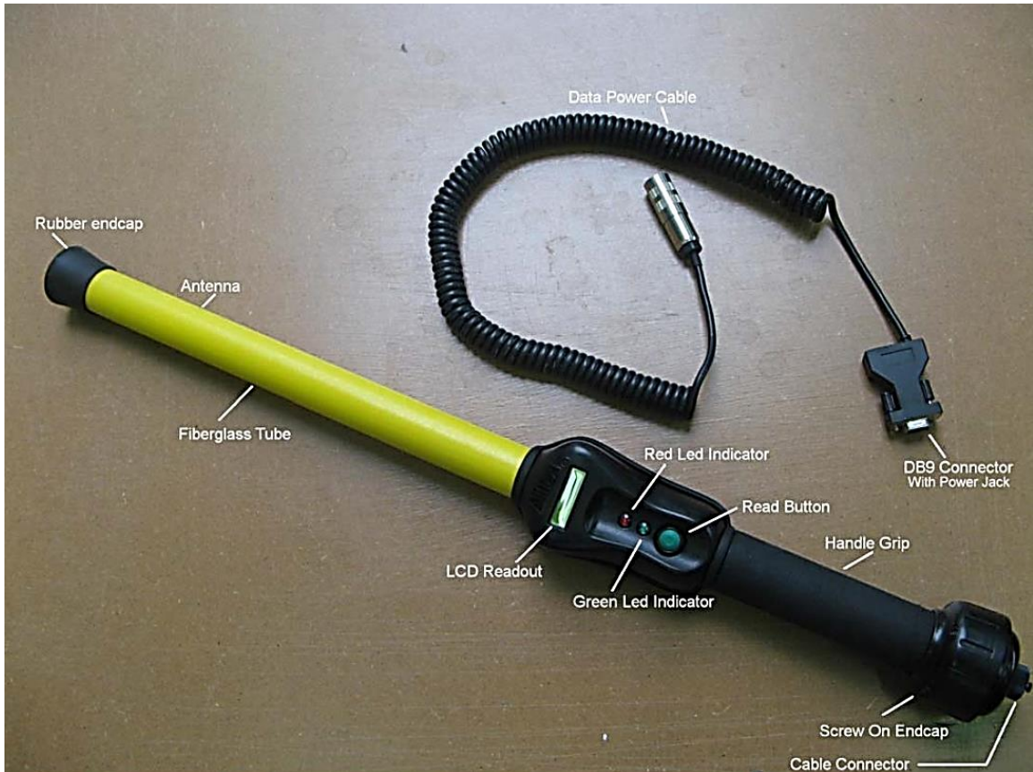
Figura AII.27 Allflex RS340™ (partes).
