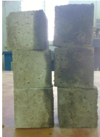
Fig. IX-17 Apariencia de los morteros curados a 75° C por 24 horas
