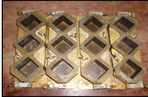
Fig. VII-5 Moldes cúbicos ASTM de bronce reforzado
