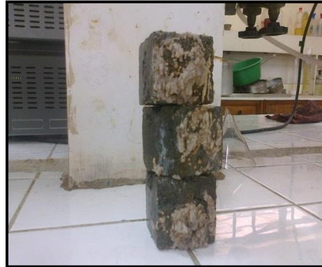
Fig. IX-15 Morteros de la fórmula óptima después del ataque químico con sulfato de magnesio
