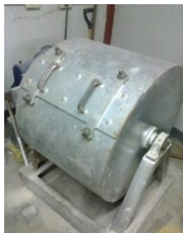
Fig. VII-2 Molino de bolas de la FTC
