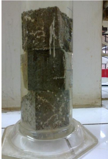
Fig. VIII-2 Prueba de ataque por ion sulfato
