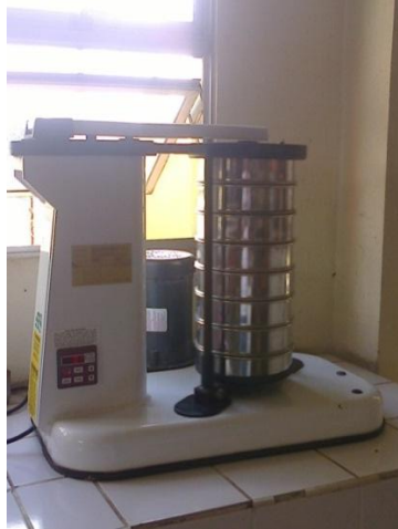
Fig. VII-3 Agitador para tamices ASTM de la FIQ
