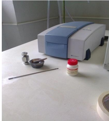
Fig. VII-9 Espectroscopio infrarrojo, KBr, mortero de ágata y espátula, para el análisis FT-IR de la FIQ
