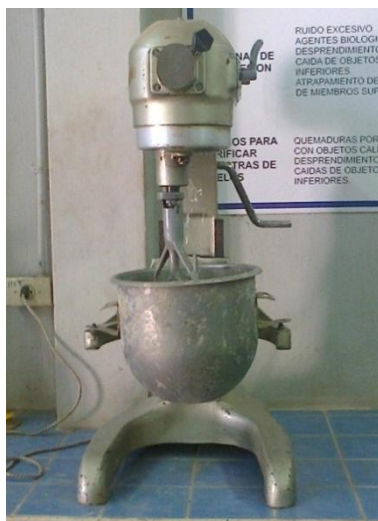
Fig. VII-4 Figuras a y b, mezcladora de movimiento planetario
