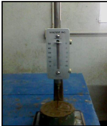
Fig. VIII-1 Ensayo para determinar el tiempo de fraguado
