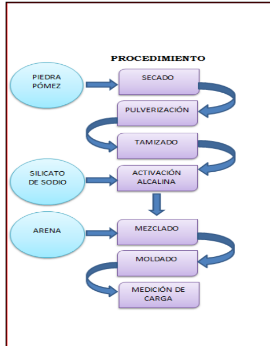
Fig. VII-10 Esquema de metodología empleada en la investigación
