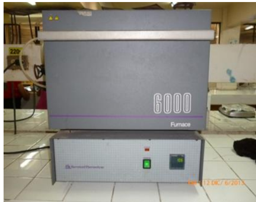
Fig. VII-7 Mufla de cámara amplia con rango de temperatura de 100-1093 °C de la FIQ
