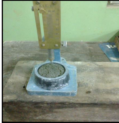
Fig. IX-3 Determinación del tiempo de fraguado para la pasta geopolimérica con los niveles óptimos del arreglo ortogonal
