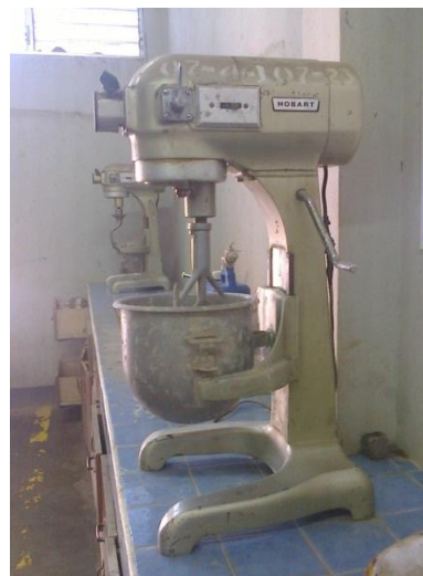
Fig. VII-4 Figuras a y b, mezcladora de movimiento planetario
