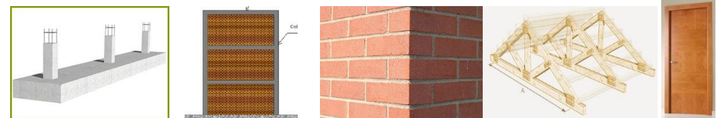
Ilustración 126: Vista de cimiento corrido, mampostería confinada, ladrillo sisado, cercha de madera y puerta barnizada.
