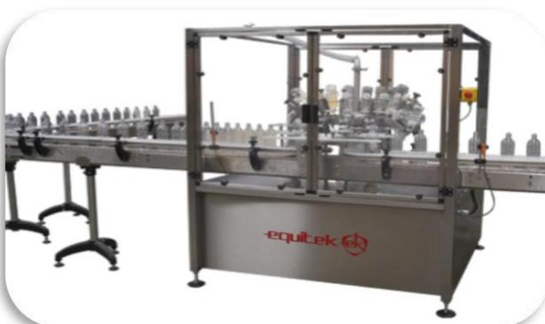
El enjuagador automático lineal de envases, está equipado con 6 boquillas de enjuagado y sistema de mordazas para manejo de envases, con extensión de transportador de 1.5m de largo, para acoplarse a equipo de envasado.
