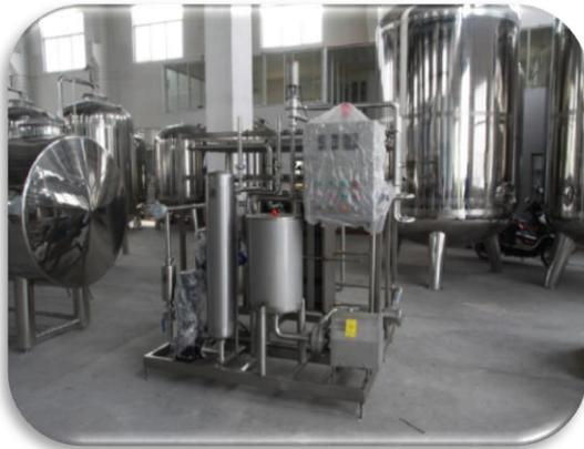
Esta máquina esterilizadora de alta temperatura usa un sistema automático de tratamiento de altas temperaturas, y es recomendable para la leche, jugo, diversos tés o productos similares para la esterilización continua. La compañía de las máquinas BR de tipo esterilizadoras tiene una capacidad de producción 1-30 T/H, una esterilización de temperatura de 85<sup>0</sup>-138<sup>0</sup>C.
