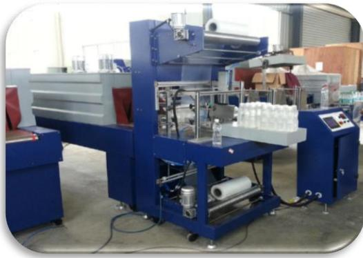
La máquina de embalaje es utilizada para agrupar y envolver las botellas ya etiquetadas y frías.
