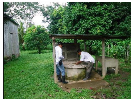
Foto 22. Levantamiento de Nivel estático de los Pozos de la comunidad. Fuente Domínguez-Mora, 2013.
