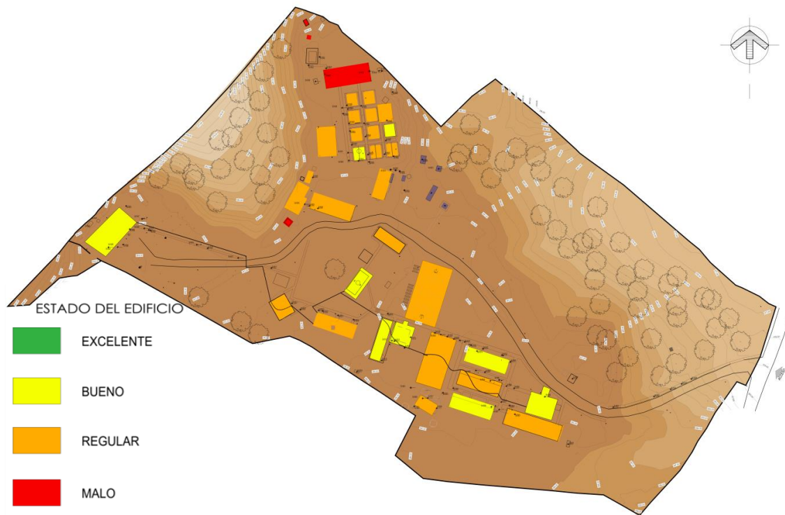
Ilustración 17. Plano de Daños del Recinto. Fuente Domínguez-Mora, 2013.
