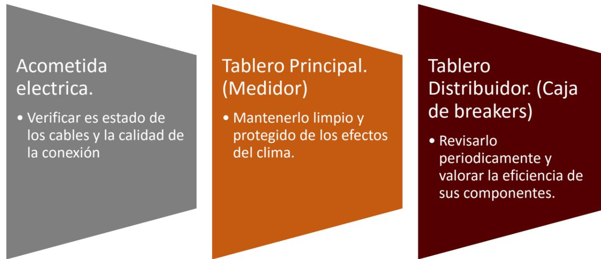
Diagrama N° 7: Diagrama de Componente del Sistema Eléctrico.
