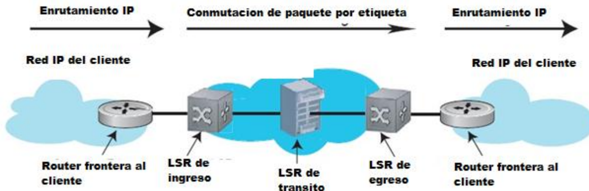
Figura. 4-5 Elementos de red MPLS
