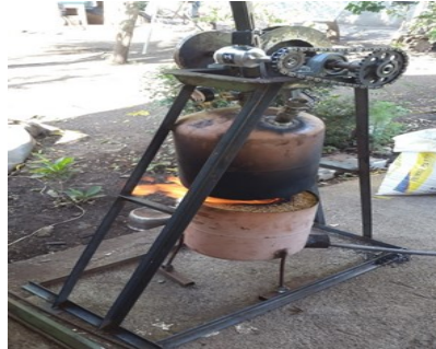
Figura N° 1 (Generador de energía eléctrica a base de cascarilla de arroz y cascarilla de café).
