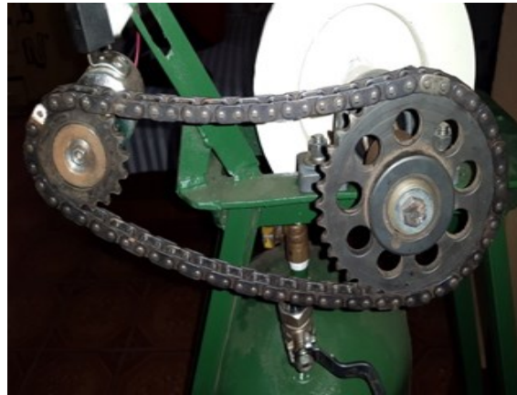
Figura N° 8 (Engranaje mayor de acople y engranaje menor).
