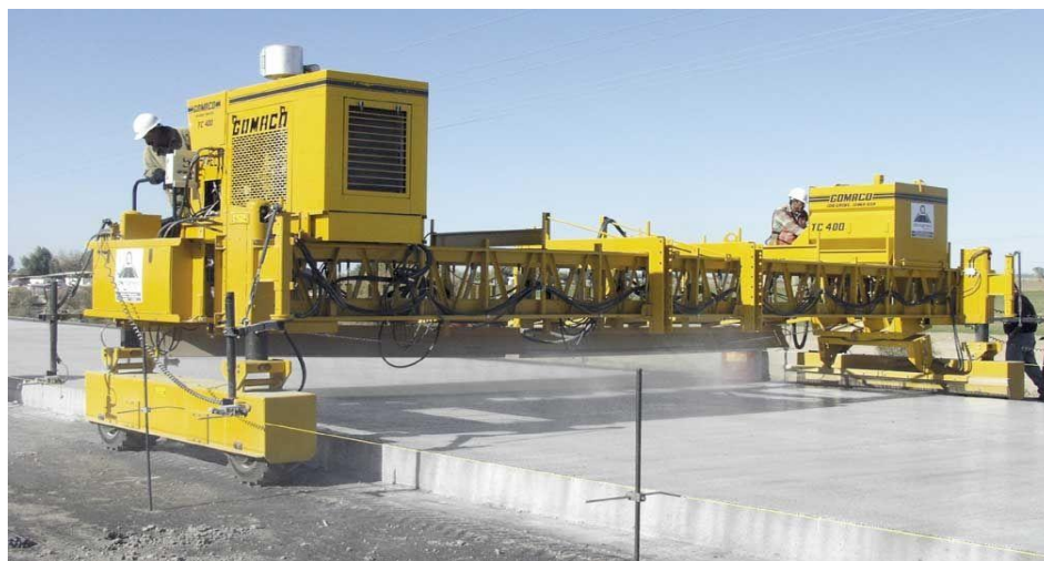
Figura 19. Equipo automático de curado.
