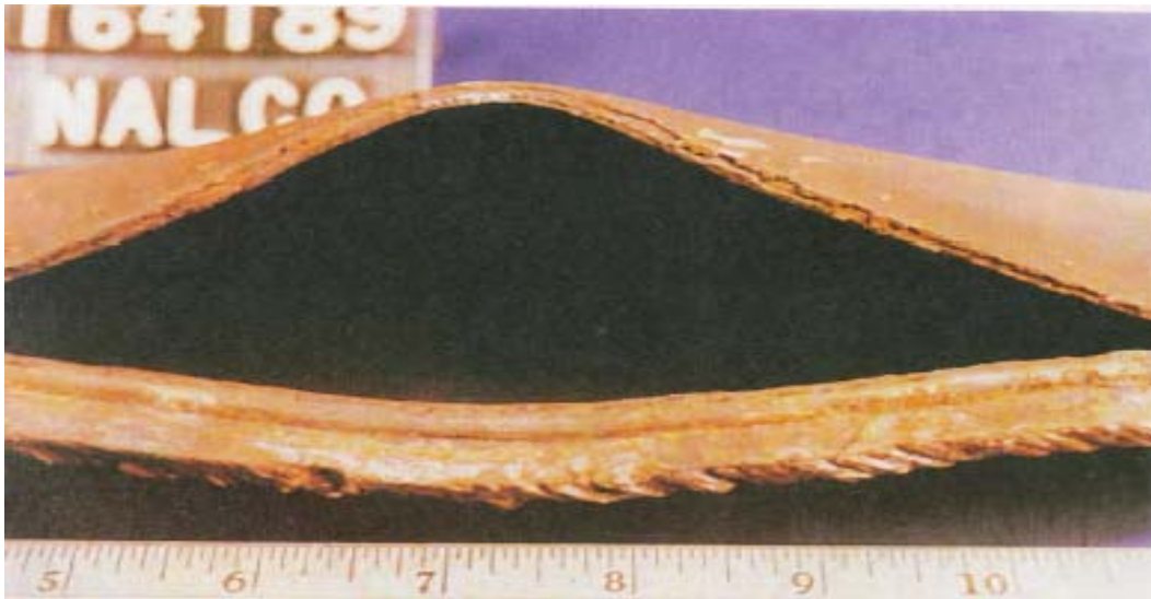
Fig. 3.9 Fractura masiva a lo largo del cordón de soldadura resultante de la grafitación relacionada con el proceso de soldadura
