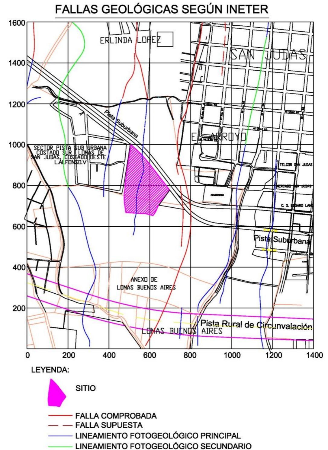
Ilustración 14: Fallas geológicas en el sitio / Escala gráfica Fuente: INETER
