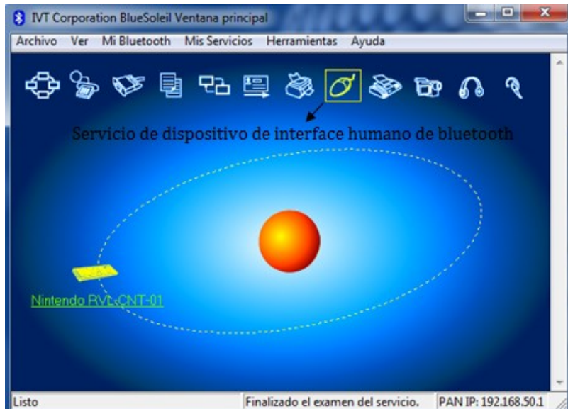
Figura 21. Habilitación del servicio de dispositivo de interface humano de bluetooth
