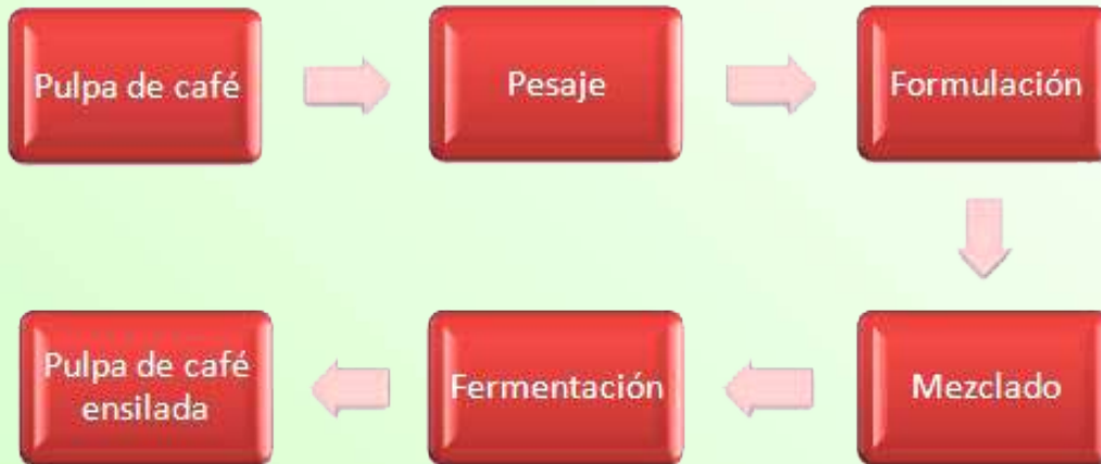
Figura: Diagrama de bloques del proceso de elaboración del alimento, utilizando como materia prima la pulpa de café
