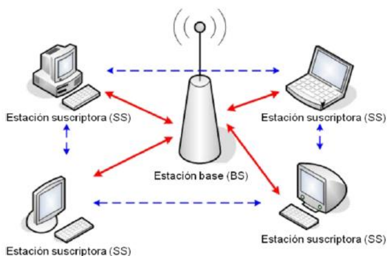
Figura 30: Funcionamiento del estándar IEEE 802.16d (Fuente: [15])
