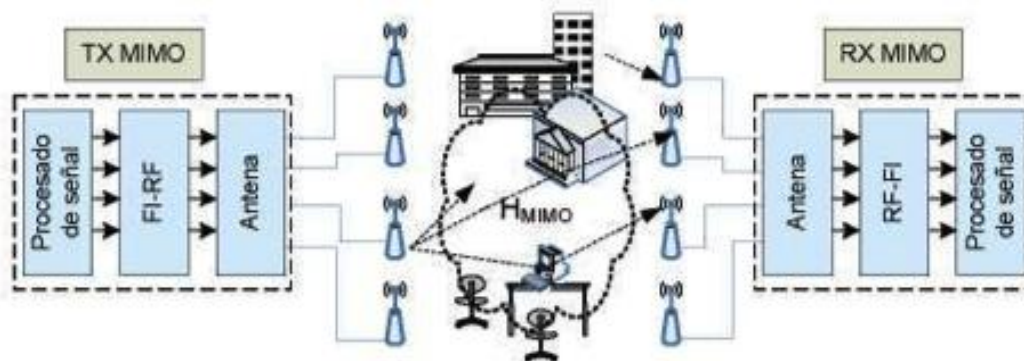
Figura 39: Arquitectura del Testbed MIMO-OFDM (Fuente [18]).
