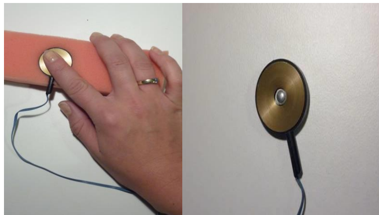
Kuva 5.3. Oikealla C-2 Aktuaattorin keskellä näkyy värähtelyitä tuottava kontaktori ja ympärillä oleva passiivinen kotelo. Vasemmalla osallistujan etusormi on aktuaattorin päällä.
