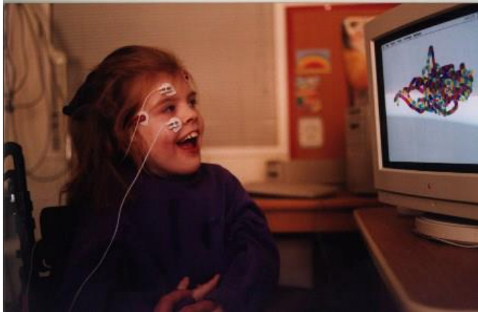
Kuva 2.4. EOG tekniikalla toimiva katseenseurantalaite EagleEyes projektista [Gips & Olivieri, 1996]
