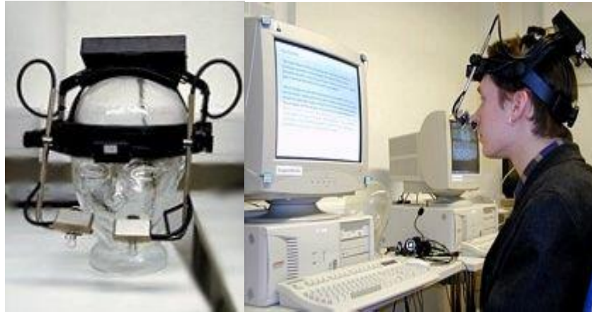
Kuva 2.3. Päähän kiinnitettävä katseenseurantalaite EyLink (kuvat: http://www.uta.fi/sis/tauchi/virg/laboratory.html ).
