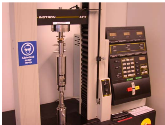
Kuva 10. Puristuskoeleuat asennettuna mekaaniseen testauslaitteeseen.
