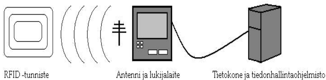
Kuva 1. Tyypillinen RFID -Järjestelmän koostumus.
