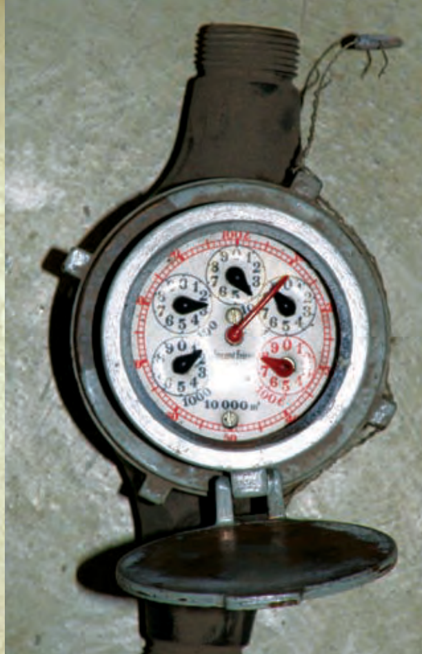
Kuva 8a ja b. Vanhojen vesimittarien kanssa piti olla tarkkana, että lukema kirjattiin oikein. Kuvan vanhat mittarit ovat vesilaitoksen varastolta. (Rajala 2009)
