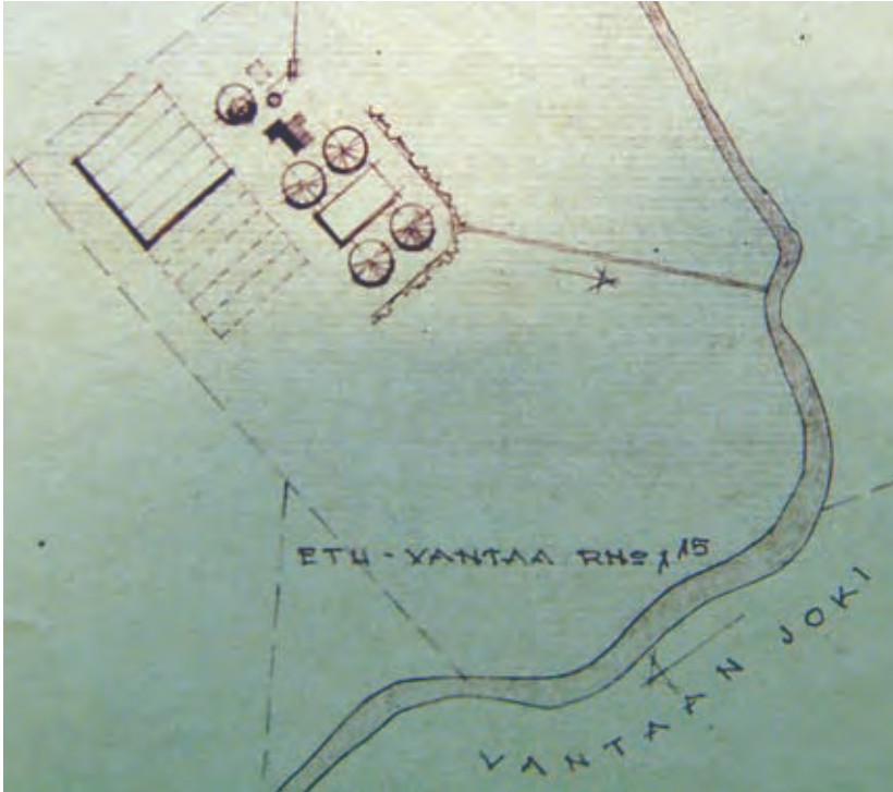
Kuva 3. YIT:n suunnitelma jätevedenpuhdistamoksi vuodelta 1957.
