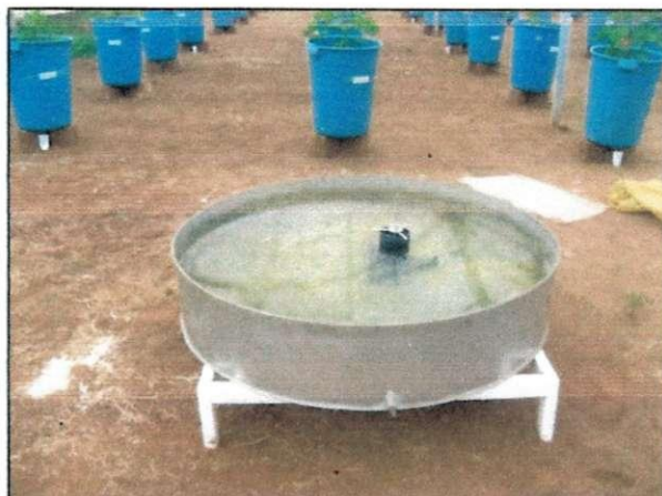
Figura 7 - Tanque classe A, instalado no ambiente interno da casa de vegetação
