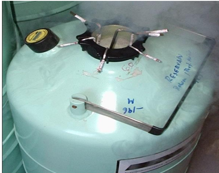
FIGURA II.15 – Botijão criogênico com canisters acondicionados
