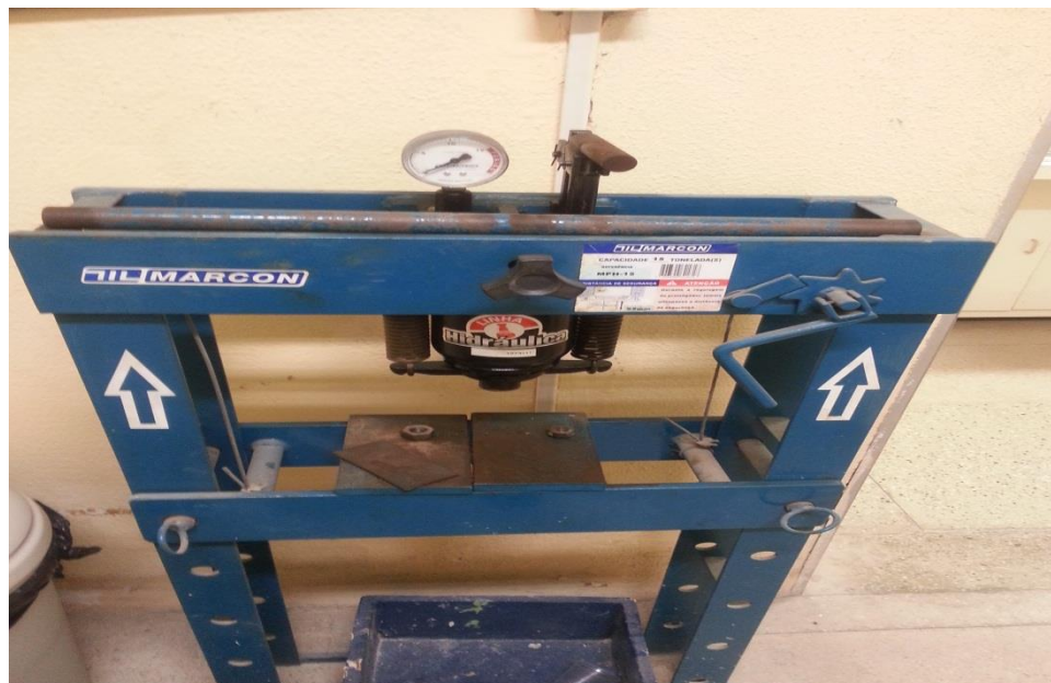
APÊNDICE O - Prensa hidráulica usada na confecção dos corpos-de-prova no laboratório de processamento mineral/DIAREN-IFRN
