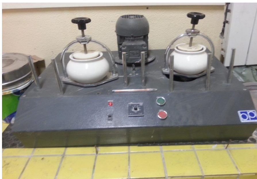
APÊNDICE D - Moinho planetário do laboratório de processamento mineral /DIAREN-IFRN, utilizado para moagem do material coletado
