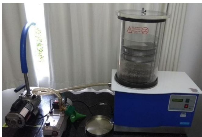
Figura 28 – Liofilizador, modelo Liotop L108 pertencente ao CERTBIO – UFCG, utilizado no trabalho.
