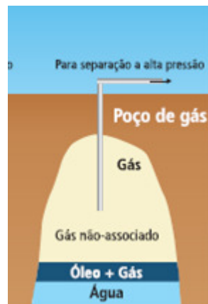
Figura 2.4: Fluxograma simplificado de Poços de Gás não associado. Fonte: Adaptado do livro “Gás Natural” da Bahiagás
