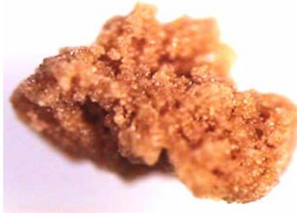
Figura 4.44 – Imagem do grânulo de quebra pedra sem recobrimento (25 X).
